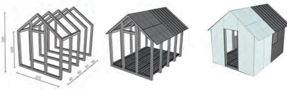
STRUTTURA A TELAIO MODULARE PARTIZIONI ORIZZONTALI PARTIZIONI VERTICALI
