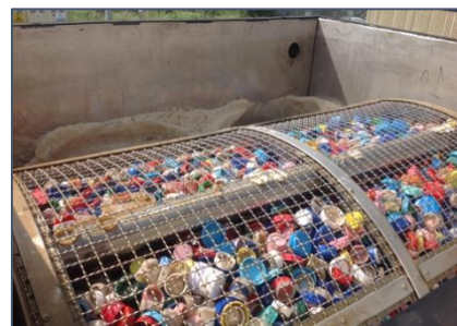
Particolare interno della macchina RCBR, i carriers sono tappi di bottiglia usati.
