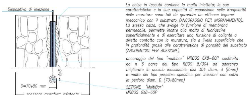
Particolare ancoraggio del tipo MRBOS 6X8-60P-scala 1:10
