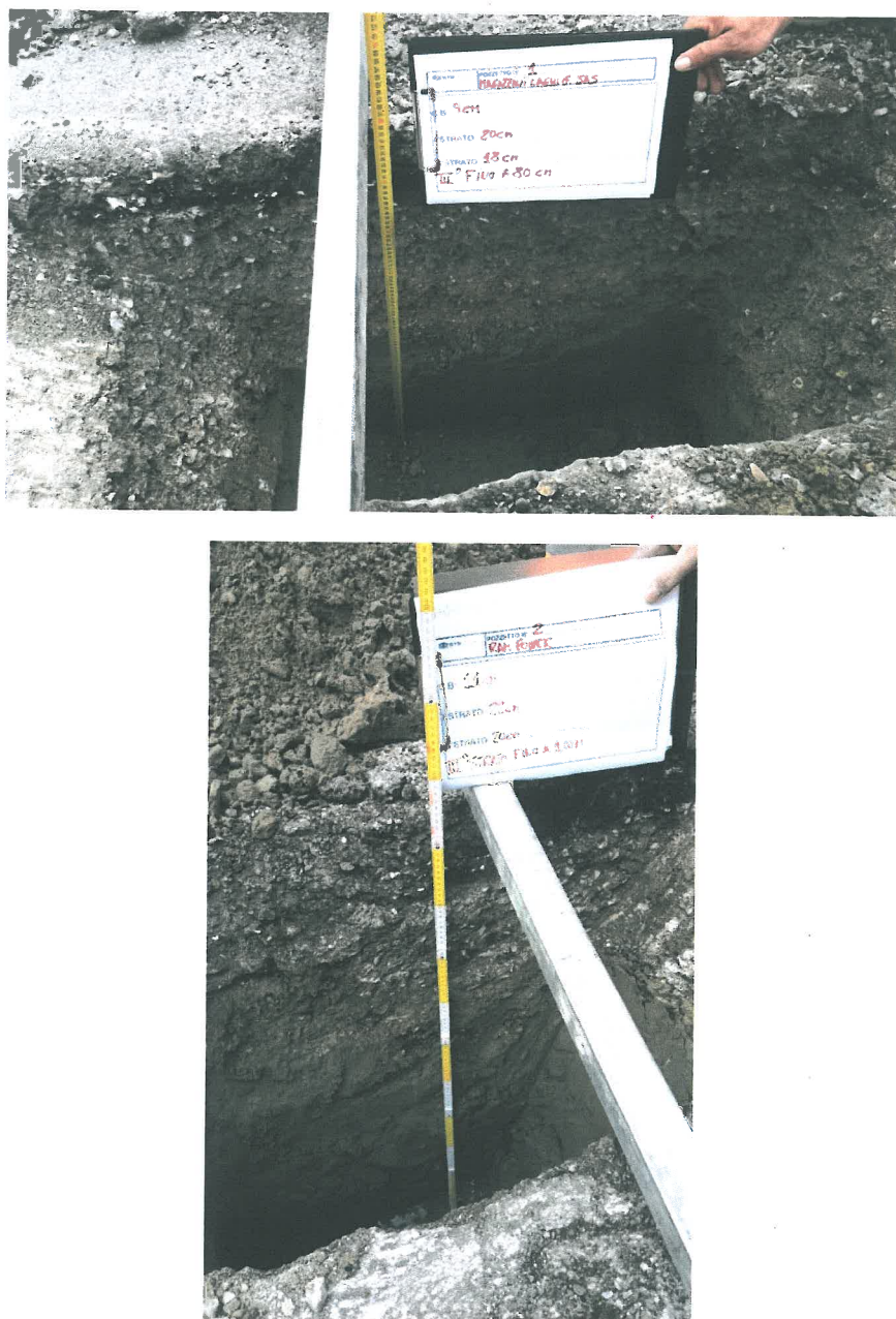
Figura 4. Verifica della stratigrafia e dei materiali degli strati di fondazione e sottofondo
