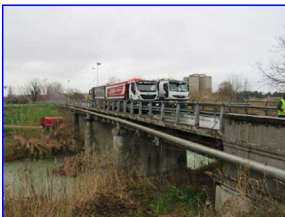
Fasi di carico su III e IV campata da sinistra
