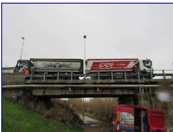
Fasi di carico su I e II campata da sinistra
