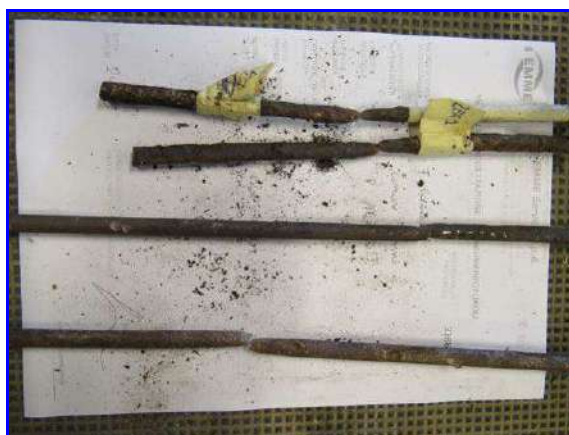
Campioni dopo la rottura
