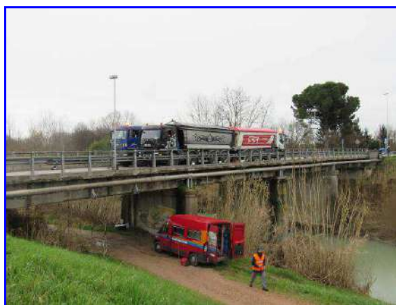
Fasi di carico su I e II campata da sinistra
