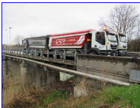
Fasi di carico su III e IV campata da sinistra
