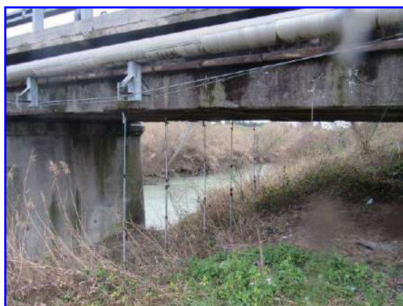
Sensori inclinometrici e differenziali
