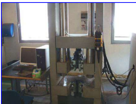
Macchina per la prova di trazione
