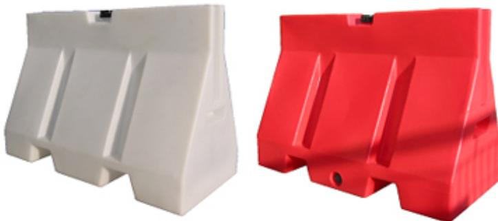
Prodotto in polietilene di colore bianco, rosso o giallo resistente alle basse temperature ed ai raggi solari (UVA-UVB). Predisposto per il collegamento degli elementi tra loro è indicato per la delimitazione di cantieri, rotonde ed altre situazioni temporanee. Il prodotto è cavo all'interno per essere zavorrato con sabbia o acqua.
