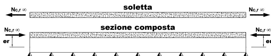
Figura 2.1 – Schema delle azioni da ritiro
