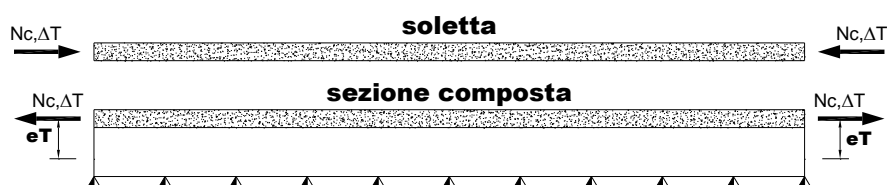
Figura 2.4 – Schema delle azioni per variazione termica positiva
