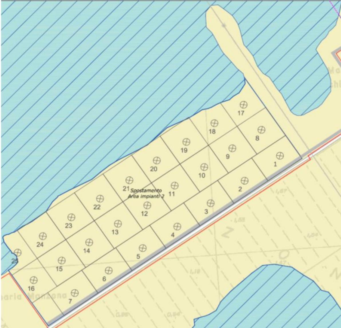
Figura 4 - Suddivisione dell'area di caratterizzazione in maglie di dimensioni omogenee. Di forma rettangolare per le maglie da 1 a 7, di forma quadrata per le maglie da 8 a 25.
