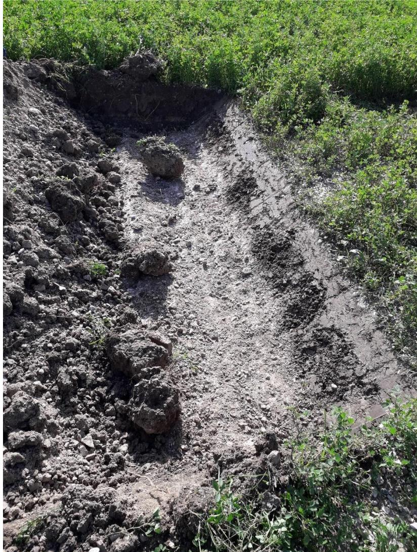
*Figura 7 - Maglia di campionamento T2, presenza di materiale di riporto nei primi 30 cm dello scavo.*
