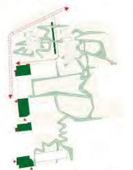
Disgiunzione parcheggi e percorsi in graver per la totale percolazione dell'acqua meteorica
